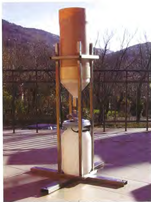
Fig. 2 - Pluviometro per la raccolta di pioggia o neve da sottoporre ad analisi isotopiche. Consigliato dall'IAEA di Vienna (Agenzia atomica delle Nazioni Unite).
