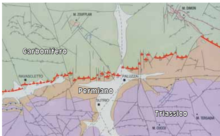
Fig. 75 – La carta geologica (semplificata e senza base topografica) mostra la posizione della faglia Comeglians-Paluzza-Paularo (faglia Com-Pa-Pa, CP), un piano orientato est-ovest ed inclinato circa 60° verso nord. Come si nota è stato ovunque spezzettato e traslato da piccole faglie più recenti.
